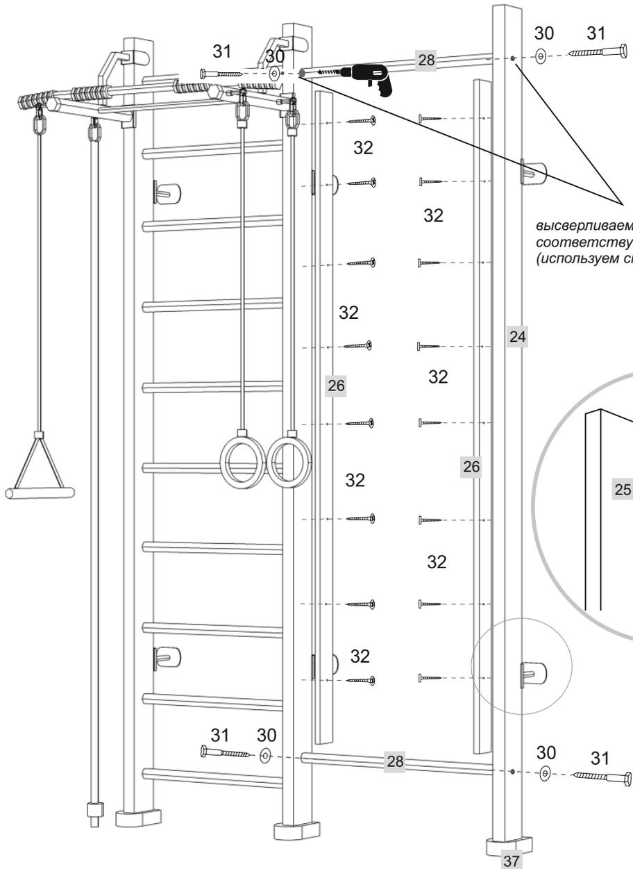
*высверливаем в стойке ДСК отверстия, соответствующие на стойке для скалодрома (используем стойку №25, как шаблон)*
