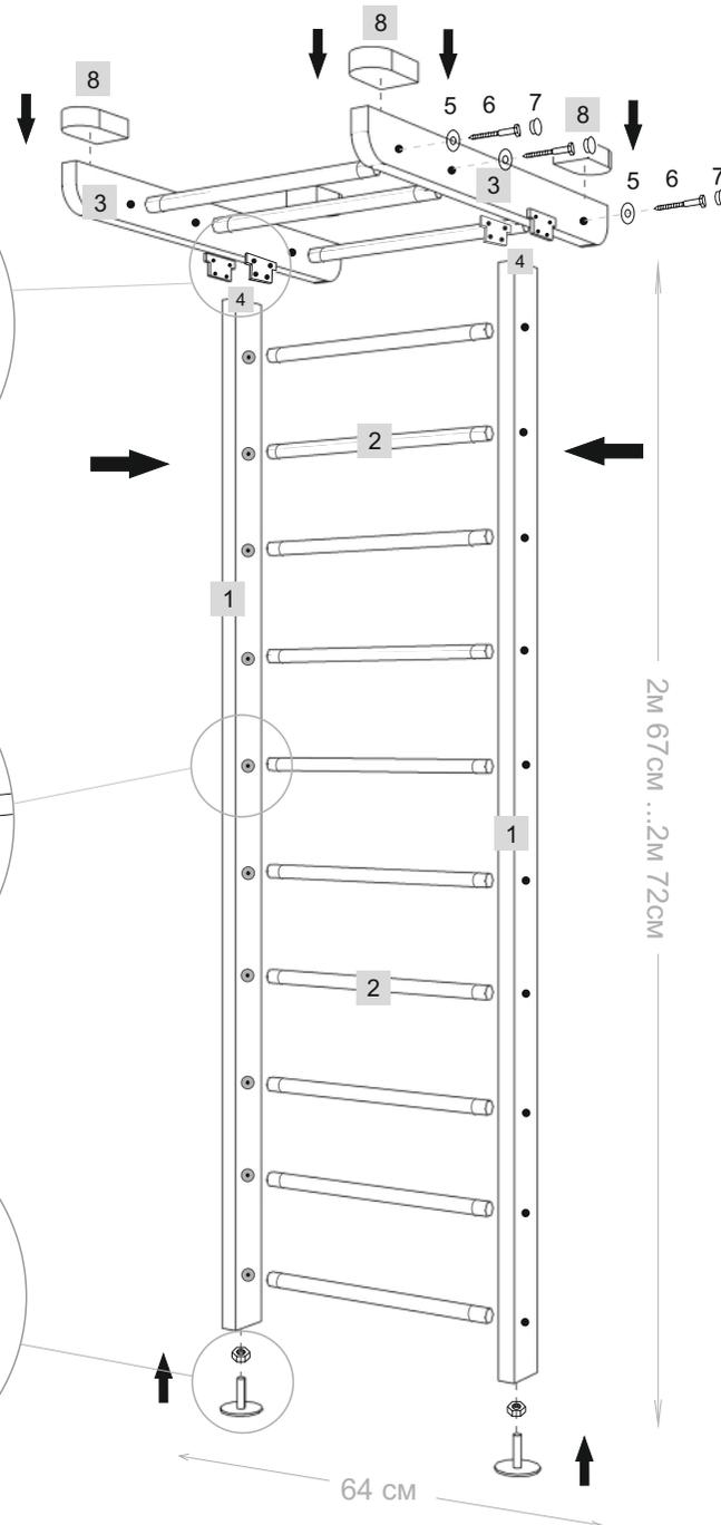
собираем нижнюю часть крепления и за счет болта №11 регулируем высоту
