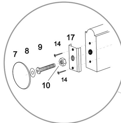
собираем нижнюю часть крепления и за счет болта №10 регулируем высоту
