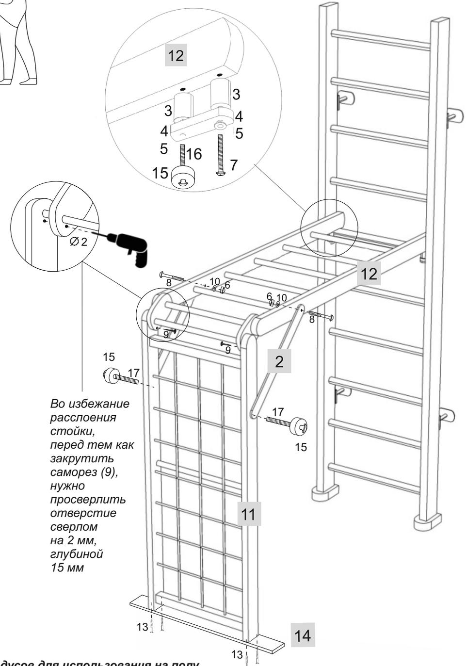
Во избежание расслоения стойки, перед тем как закрутить саморез (9), нужно просверлить отверстие сверлом на 2 мм, глубиной 15 мм
